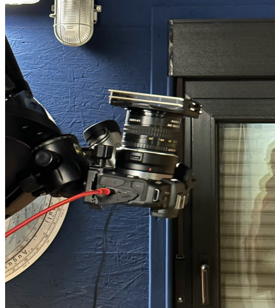
Abbildung 4.5: Kamera mit Objektiv und Filter fertig zusammengesetzt am Teleskop befestigt
