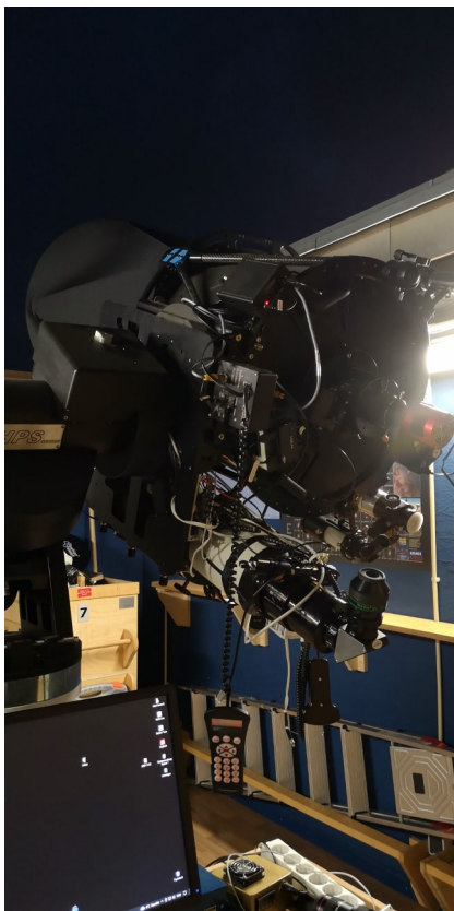
Abb. 3.1: Teleskop Planewave CDK 20 - Öffnung: 50,8 cm, f/6.8, Brennweite: 3454 mm
