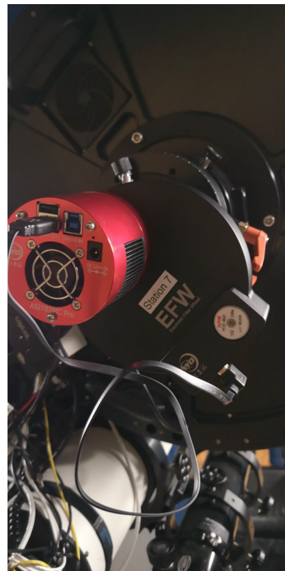
Abb. 3.2: CMOS-Astrokamera Pixelgröße: 2.4 \mu\text{m} Auflösung: 5496 \times 3672
