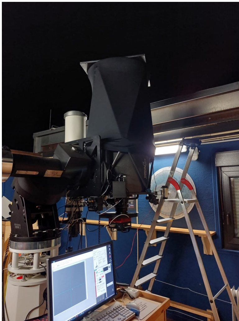
Abbildung 6.8: Aufnahme von Flatframes mithilfe einer LED-Leuchtplatte
