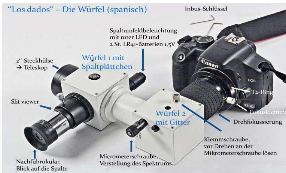
Abb. 7: Aufbau DADOS Spektrograf
