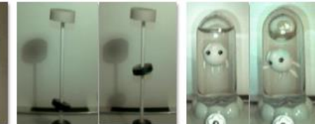
Vor und während der Schwerelosigkeit: Verformung von Flüssigkeiten, magnetische Abstoßung, Ausdehnung einer Luftblase im Wasserglas
