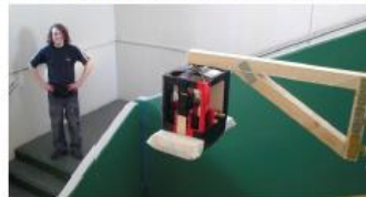
Die Getränkebox ist mit einem Fallexperiment bestückt! Nach rund 2 Sekunden freien Falls in Schwerelosigkeit erfolgt die weiche Landung.
