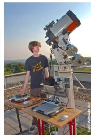
Insel 6 und Insel 1 mit Astro-Physics AP900-Montierung und Celestron 11 EdgeHD-Teleskopen, Teleskopsteuerung per Notebook.
