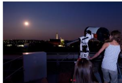
Insel 6 und Insel 1 mit Astro-Physics AP900-Montierung und Celestron 11 EdgeHD-Teleskopen, Teleskopsteuerung per Notebook.
