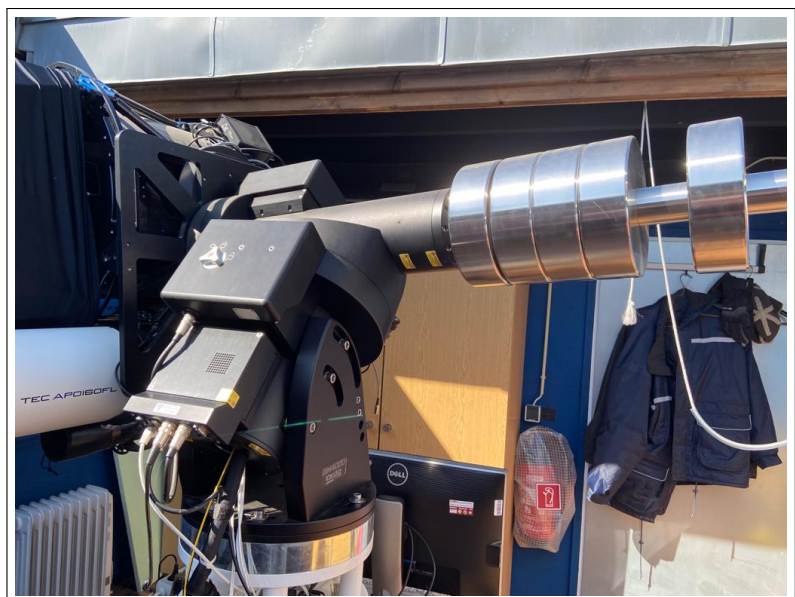
Abbildung 5.5: Die 10Micron GM4000 Teleskop-Montierung der Station sieben
