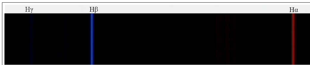
Abbildung 2.8: Wasserstoffspektrum, aufgenommen und bearbeitet mit Spectral-Explorer Spektrograf/Software von Lukas Hoyer
