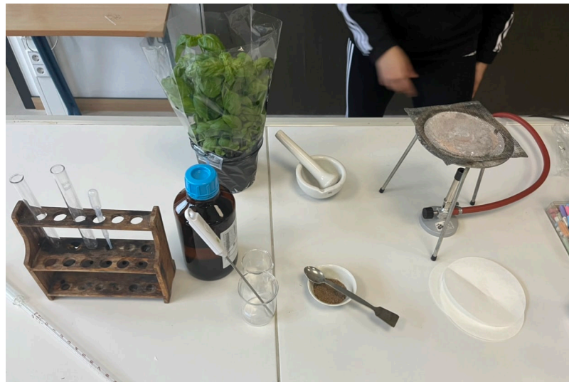
Hier ist unser Versuchsaufbau abgebildet die Reagenzgläser, die Pipetten, das Thermometer, das Aceton, das Basilikum, der Löschsand, der Mörser und der Brenner
