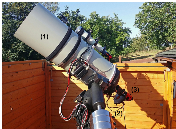
Abb. 3.1: Ausrüstung der Aufnahme: (1) Optik: 0.36\text{ m} Schmidt-Cassegrain Teleskop, (2) Filterrad mit UV/IR-Sperrfilter, (3) Kamera: ZWO ASI6200MM Pro
